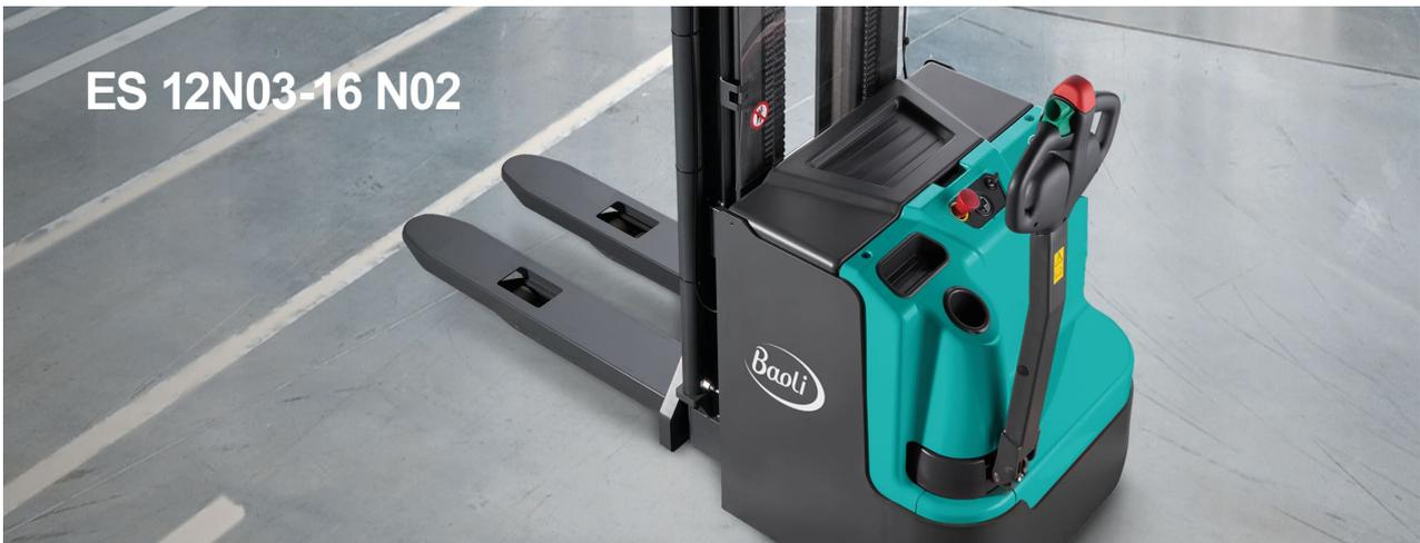
Gli stoccatori Baoli ES 12-N03 e ES 16-N02 sono perfetti per il trasporto e lo stoccaggio di carichi da 1200 a 1600 kg. Il modello ES 12-N03 presenta una batteria piombo acido da 24 V / 180 Ah. Il modello ES16-N02 è dotato di una batteria di maggiore capacità da 24 V / 270 Ah. Grazie al funzionamento sensibile e ai comandi operativi proporzionali, questi stoccatori offrono un'elevata efficienza di movimentazione. Il lungo braccio del timone assicura un controllo del
