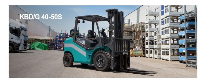
Per gli impieghi più pesanti, Baoli offre i carrelli KBD 40 e KBD 50S con motore diesel e i carrelli KBG 40 e KBG 50S con motore GPL. Questi carrelli elevatori sono disponibili con capacità di carico di 4,0 e 5,0 tonnellate con baricentro di 500 mm.
