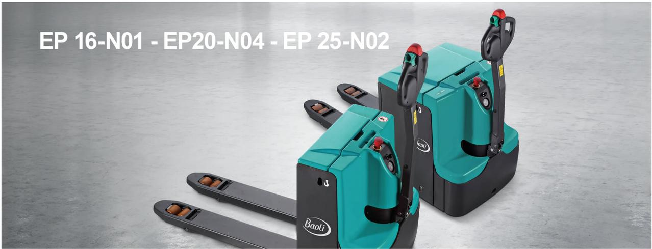
I transpallet EP 16-N01, EP 20-N04 e EP 25-N02, con una capacità di carico rispettivamente di 1600, 2000 e 2500 kg, sono perfetti per il carico e lo scarico di camion e per qualsiasi tipo di movimentazione a media intensità. L'elevata qualità costruttiva e l'eccellente contenuto tecnologico fanno di questi transpallet un vero e proprio punto di riferimento nel loro settore. I modelli EP 16-N01, EP 20-N04 e EP 25-N02 garantiscono la massima efficienza e costi di manutenzione ridotti.
